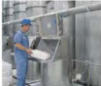
Staubarme Containerbefüllung durch Besaugung.
