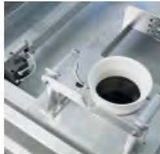
Aufgabestation für DOSITAINER® mit automatischer Dosierschneckenöffnung.
