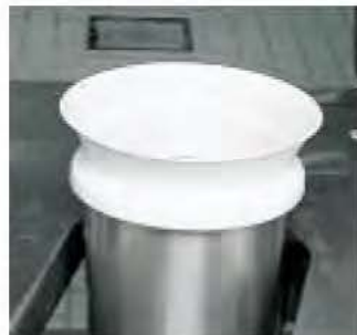
Die patentierte Andockmanschette ist leicht zu reinigen.
