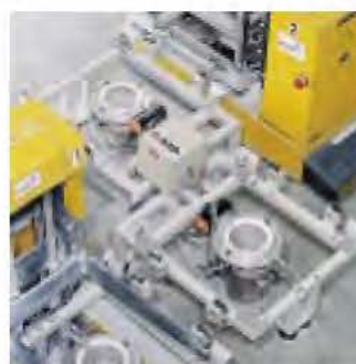
Vollautomatische, kontaminationsfreie Produktaufgabe mit pneumatischer Doppelklappe.
