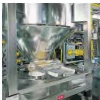
Kontaminationsfreie, manuelle Produktaufgabe durch Modulschieber.
