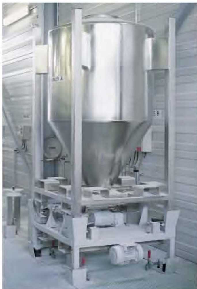
Die Aufgabestation mit integriertem Dosierschneckenantrieb und aufgesetztem DOSITAINER®.
