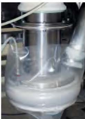
Staubdichtes Andocken an der Aufgabestation oder anderen Systemen durch die Blähmanschette oder die patentierte Andockmanschette.
